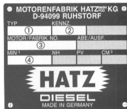
Fig. Número de série do motor HATZ
