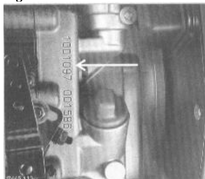
Fig. Número de série do motor HATZ
